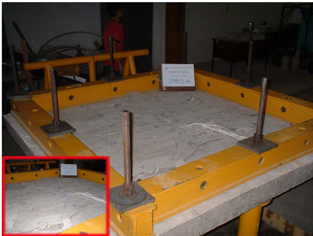
Figura 6.66 - Fissuras desenvolvidas na face superior da laje L5
