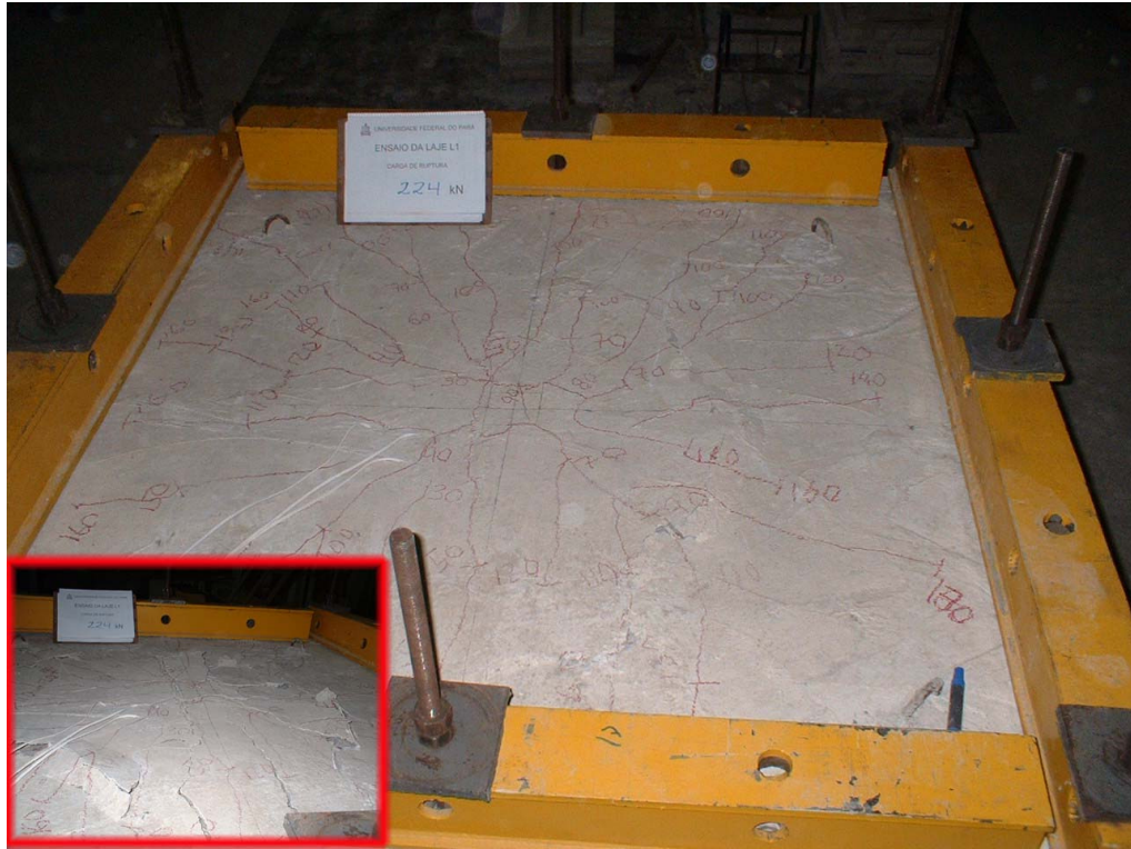
Figura 6.58 - Fissuras desenvolvidas na face superior da laje L1
